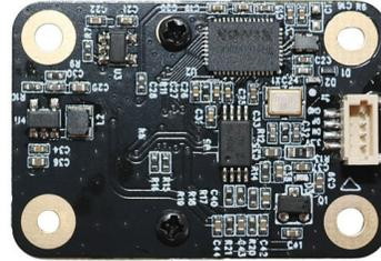
YDS-PS-USB-OV9732 V1.0 ist ein 1MP-USB-2.0-Kameramodul mit festem Fokus, das auf einem 1/4-Zoll-OV9732-Bildsensor basiert. Es liefert schnelle, hochauflösende, ultrascharfe Bilder. Der S-Mount-Objektivhalter (M12) ermöglicht es Kunden, je nach Anwendung unterschiedliche Objektive auszuwählen. Dieses Kameramodul ist die ideale Lösung für Gesichtserkennung, Identitätserkennung, Automobilindustrie und Zugangskontrolle.
